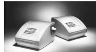
erreur de remplissage et la fonction U-View™ affiche une vidéo en direct de l'alimentation de la cellule de mesure pour permettre l'inspection visuelle. Pour garantir un degré maximal de sécurité lors du remplissage, une pompe péristaltique, assurant un remplissage sans bulle, est proposée en option. Les données de mesure sont enregistrées en même temps que les images U-View™ correspondantes de la cellule de mesure pour une vérification ultérieure.
